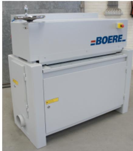
Die Bürstenmaschine ist speziell für die Reinigung von Teppichfliesen, Automatten, usw., entwickelt worden und ist deshalb sehr für den Verleih geeignet. Die spezielle Konstruktion der Fiberbürste sorgt dafür, daß die Fliesen in die richtige Haarrichtung gebürstet werden, wodurch die Fliesen als neu die Maschine auslaufen.
