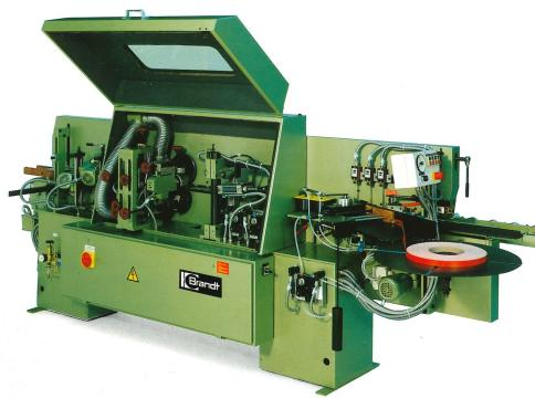
Mit den Typen KM 22 + KM 23 bieten wir den Einstieg in unsere Durchlauf-Kantenanleimmaschinen. Mit Normalfrequenz-Bearbeitungsaggregaten bestückt, können Kantendicken bis zu 5 mm sicher bearbeitet werden. Die KM 22 ist standardmäßig mit Kappund Bündigfräsaggregat bestückt, die KM 23 bietet zusätzlich noch einen Freiplatz, auf dem wahlweise Feinfräs-, Bandschleif- oder Schwabbelaggregat aufgebaut werden können. Standardmäßig mit einem Kantenmaga-
