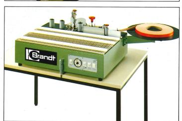
KTV 12: Ebenfalls eine Neuentwicklung, bietet die KTV 12 viel Leistung auf kleinem Raum: automatische Kantenzuführung – elektromagnetische, fußschalterbetätigte Rollentrenneinrichtung – thermostatisch regelbare Heißlufttemperatur – motorisch angetriebene Andruckrollen – Rotationsmesser-Bündigschneidaggregat.
