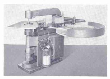
WB 64 zum Anbringen von PVC-Profilen an umlaufende Kanten im Rundlaufverfahren
