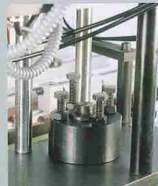
CARRUSEL TOPE VARIABLE DE PROFUNDIDAD DEPTH VARIABLE STOP CAROUSEL
