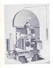
Vollautomatische Trennbandsäge HYDROSTAR mit Doppelwalze -Antrieb hydraulisch gesteuert - Elektrische Einstellung der Schnittdicke mit Servo-Set und Fernbedienung - Automatische Blattspannung und Druckführung.
