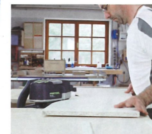
Höhenverstellbarer Arbeitsplatz mit Vakuumeinrichtung in Kombination mit Arbeitsfläche Hobelbank.
