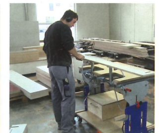
Höhenverstellbarer Arbeitsplatz mit Vakuumeinrichtung in Kombination mit Arbeitsfläche Hobelbank.
