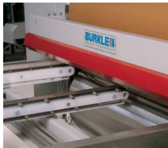
Transporter łańcuchowy ze stożkowymi bolcami podtrzymującymi Kettentransport mit umlaufenden Transportkonen
