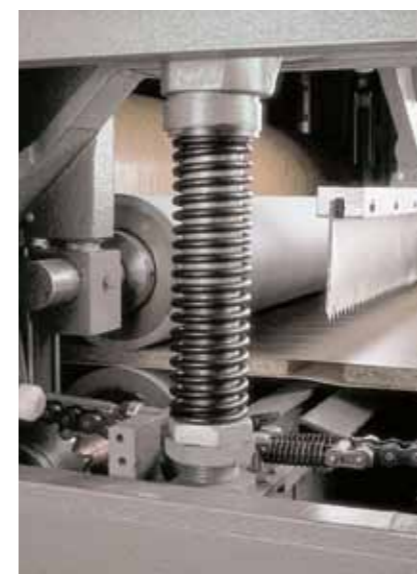
System przecinania folii: elektronicznie sterowany nóż rozcinający dla najmniejszego odstępu między elementami Folientrennung: Elektronisch gesteuertes Schwingmesser für geringsten Werkstückabstand
