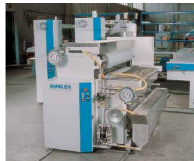
Urządzenie do nakładania utwardzacza- wysunięte z linii Härtermaschine in ausgefahrenem Zustand
