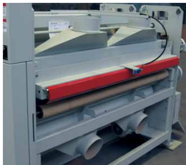
Szczotkarka do równomiernego odpylania powierzchni Bürstmaschine für gleichmäßige Entstaubung
