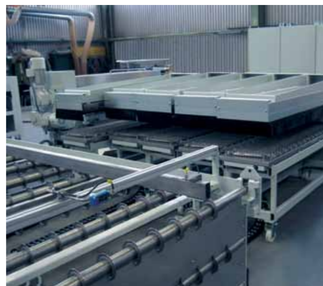
Strefa IR (wysuwana) w celu podgrzania palet IR-Zone (ausfahrbar) zur Plattenvorwärmung
