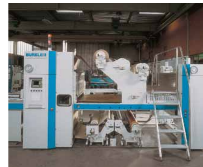
Stacja rozwijania folii z mechanizmem łączenia folii i sterowaniem miejscem łączenia folii (opcja) Folienabwickelstellen mit Folienverbindung und Nahtstellensteuerung (Option)
