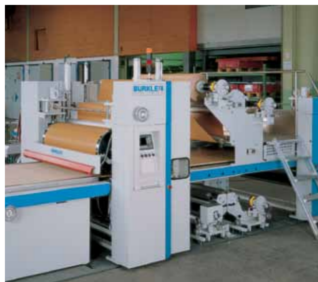
Stacja kaszerowania z dużym, ogrzewanym, stalowym walcem Kaschierstation mit großen beheizten Stahlwalzen
