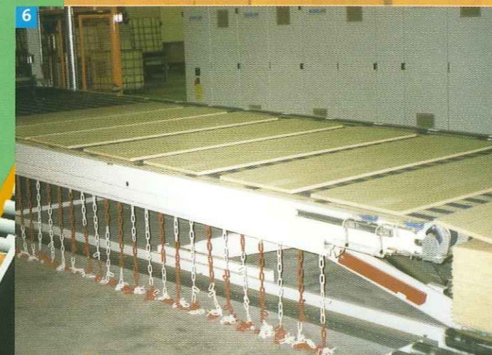
6 Auslaufrollenbahn mit Abstapelmöglichkeit in Längs- und Querrichtung. Outfeed roller track allowing lengthwise and crosswise stacking.
