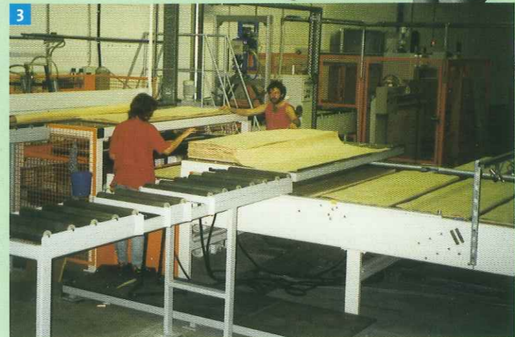
Ergonomisch gestalteten Arbeitsplatz durch automatische Platten-Ablegevorrichtung. Ergonomic working place due to the automatic board lay-up station.
