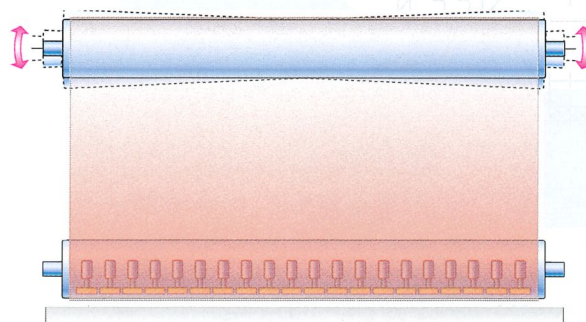
Compensation des arrêtes des bandes - le galet tendeur est construit de façon à compenser automatiquement les défauts de longueur des bandes.
