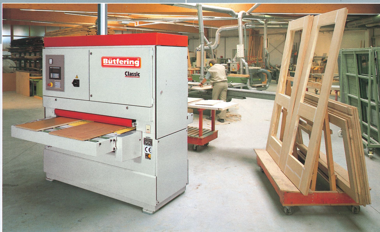
La Classic 111 C, équipée d'un agrégat combi avec rouleau de contact et patin segmenté, en exécution standard.
