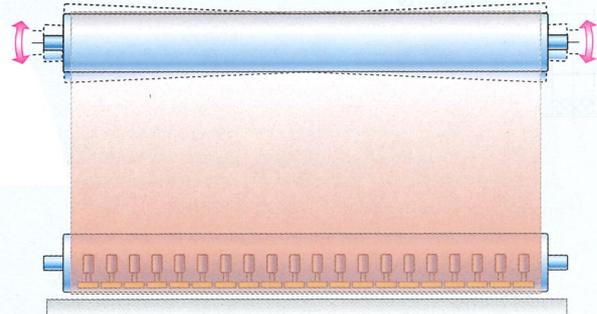
Schleifbandkanten ausgleich – die obere Umlenktrummel ist so gelagert, dass eventuell auftretende Unterschiede in Schleifbandkantenlängen automatisch ausgeglichen werden.
