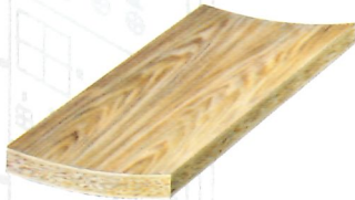
verformte Werkstücke Warped Panels
