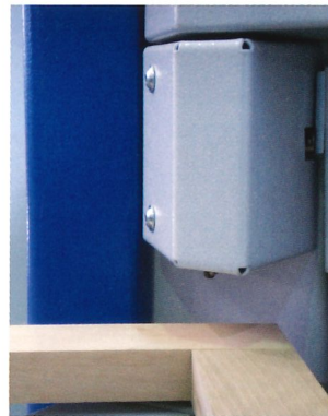
automatische Werkstück- dickenerkennung
