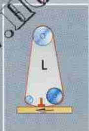
Möglichkeit 2 Feinschleifen mit dem Schleifschuh
