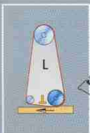
Möglichkeit 1 Kalibrieren mit abgesenkter Kontaktwalze
