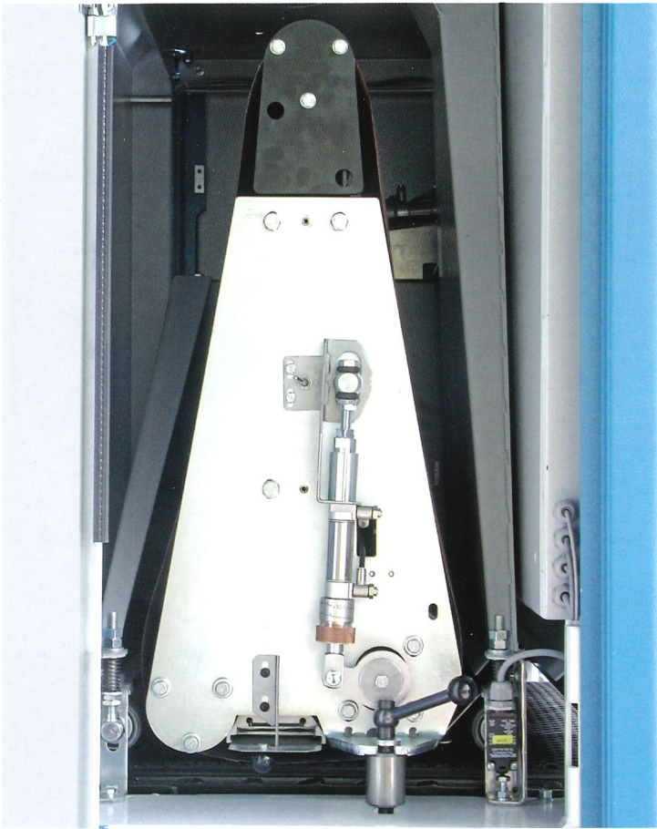
Kombi-Aggregat mit elektronischem Gliederdruckbalken
