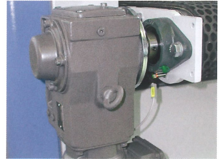
Gummiertes Vorschubtisch und stufenloser Vorschubgeschwindigkeit
