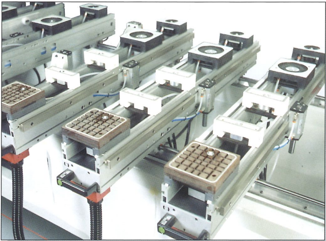
Système de blocage à ventouses, diversifiées selon la dimension des pièces. Dispositivo de bloqueo de ventosas, diferentes en función de la dimensión de las piezas.
