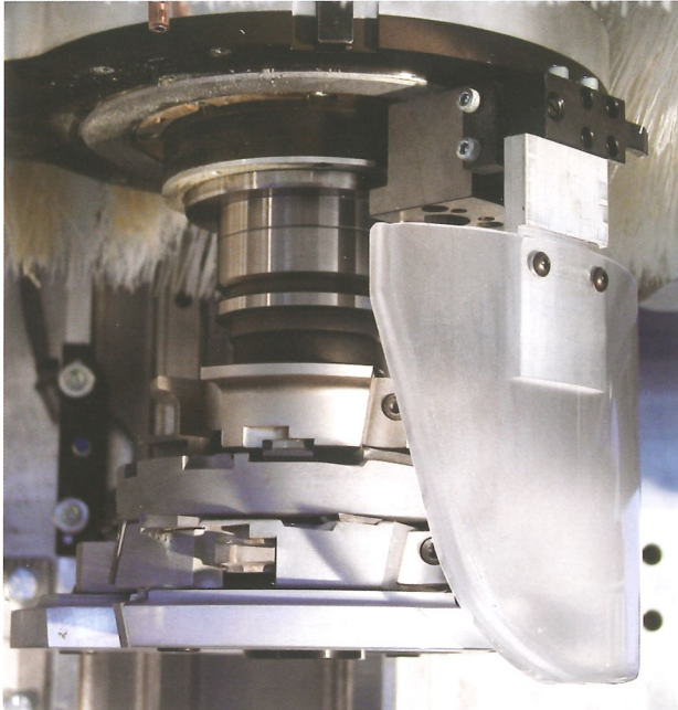
chip guard device on electrospindle Späneabweisblech auf Elektroschindel dispositif avec déflecteur de copeaux sur électrobroche
