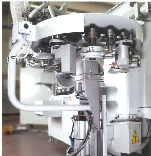
24-position rear rotary tool changer hinteres Werkzeugmagazin mit 24 Positionen magasin rotatif arrière à 24 positions
