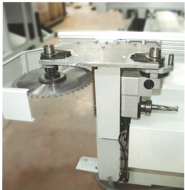
double lateral tool position for blades and large sized tools seitliches Doppelwerkzeugmagazin für Sägeblatt und große Werkzeuge station latérale double pour lame et agrégats de grandes dimensions
