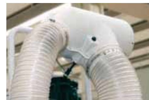
Partialized dust extraction collector Die optimale Absaugung der Maschine wird über eine zentrale Klappensteuerung garantiert Convoyeur d'aspiration partagé
