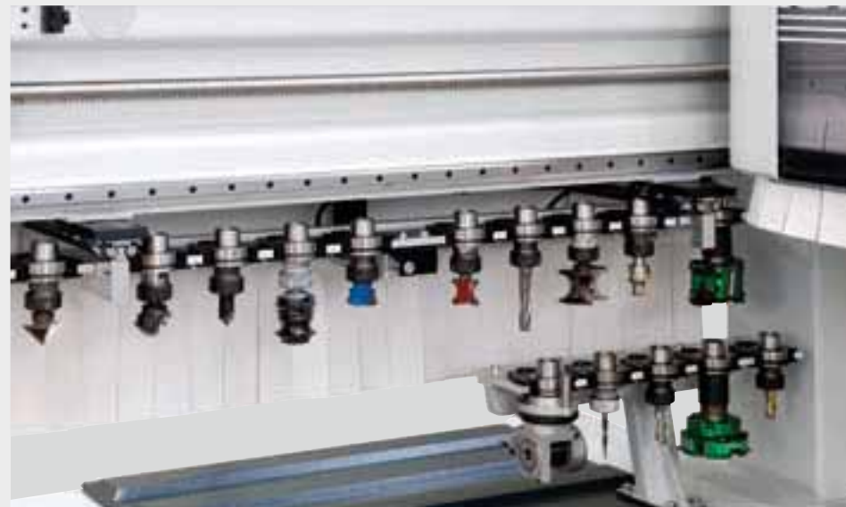
ST 10 tool changer ST 10 Werkzeugmagazin Magasin ST 10
