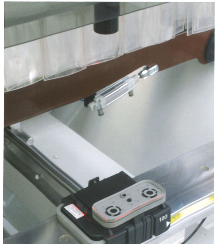
positioning system with laser indicator Kreuzlaser-Positioniersystem Système de positionnement avec indicateur laser
