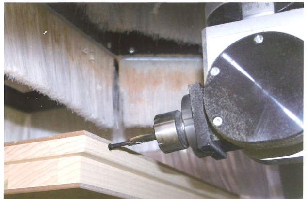
machining interior doors Bearbeitungsbeispiele von Innentüren usinage des portes intérieures
