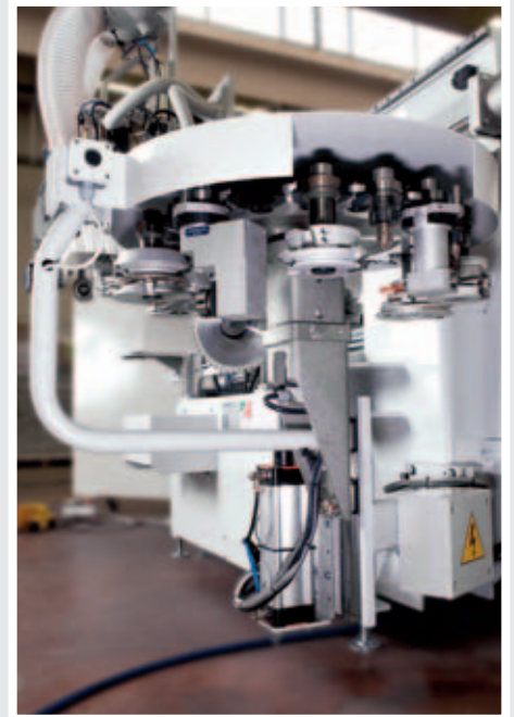
16/24-position rear rotary tool changer Hinteres Werkzeuglager mit 16/24 Positionen Magasin rotatif arrière à 16/24 positions
