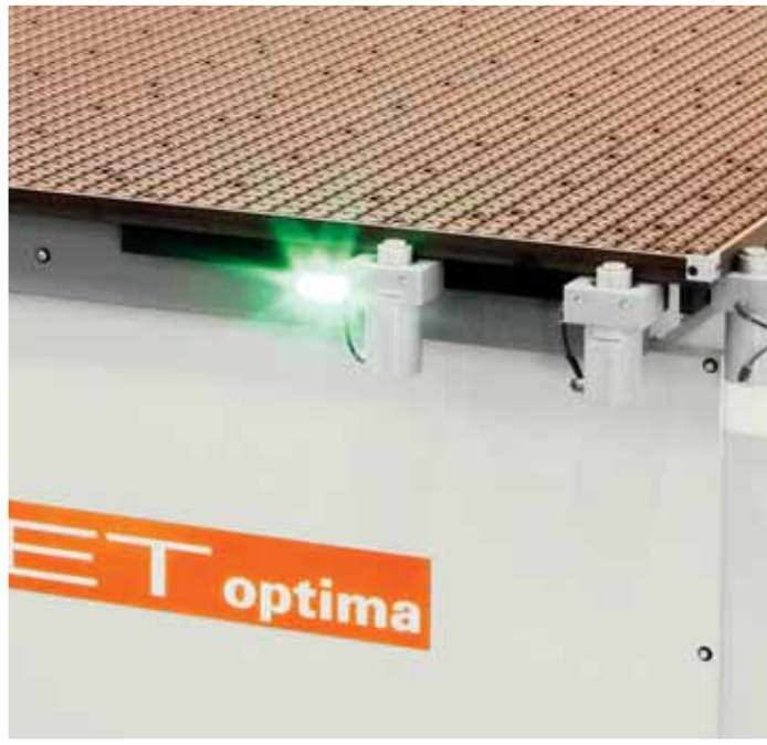
Luminous indicators to regulate access to the loading/unloading area Über led's wird dem bediener die freigabe der arbeitsbereiche signalisiert Indicateurs lumineux pour régulariser l'accès à la zone de chargement/déchargement
