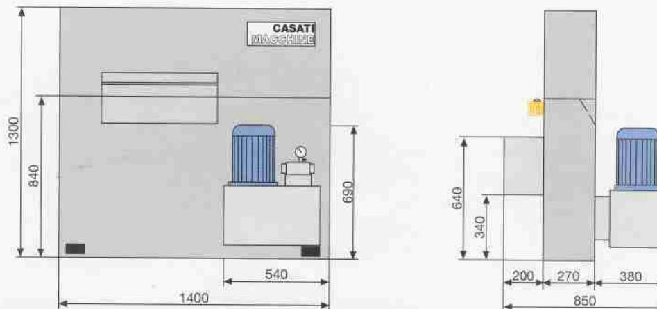
Struttura a "C" aperta sul lato anteriore, che consente di inserire il pacco di impiallacciatura anche frontalmente. Ampia visibilità della zona di taglio.
