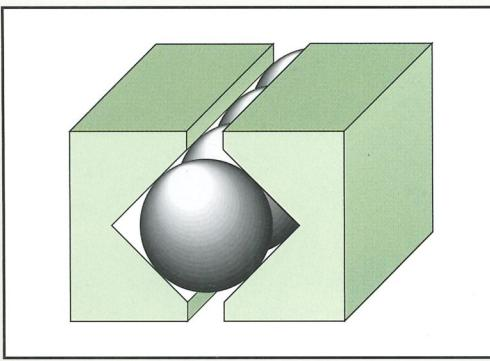
▲ Carro squadratore in lega leggera anodizzato. La struttura ha una grande resistenza alla torsione e alla flessione. Lo scorrimento avviene su guide prismatiche in acciaio speciale temperato con interposizione di sfere. (Punto di contatto delle sfere limitato per un sicuro scorrimento anche nelle condizioni più severe di lavoro).
