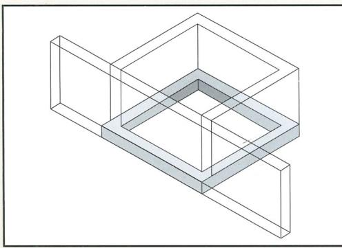
▲ Il basamento della macchina costituito dalle parti portanti in lamiera di acciaio e una base in cemento armato resistente alla torsione, garantisce precisione alla macchina, un'estrema stabilità nelle lavorazioni di pezzi molto pesanti, assorbe le oscillazioni ed il rumore è ridotto al minimo.
