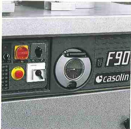
▲ Comandi elettrici con telesalvamotore avviatore  $\lambda\Delta$ , 2 sensi di rotazione albero toupie, dispositivo di emergenza e bloccaggio elettromagnetico albero toupie.
