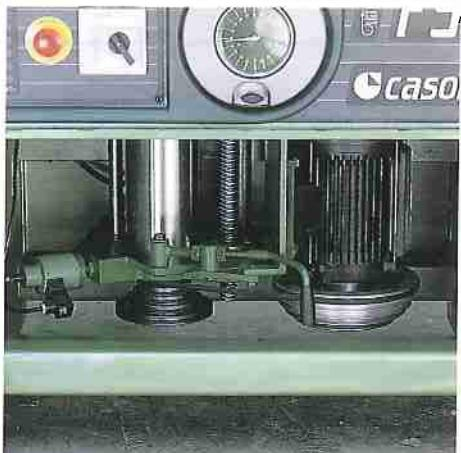
▲ **Gruppo Toupie.** Pistone di grande diametro inserito senza gioco in un lungo cilindro di guida con pratica lubrificazione dall'esterno. Albero Toupie montato su cuscinetti a sfera di precisione precaricati con lubrificazione a vita, il tutto equilibrato elettronicamente.
