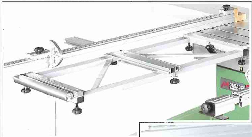
Il telaio è realizzato con tubolari in acciaio, tale struttura è molto leggera e garantisce un'elevata rigidità.
