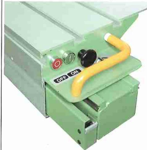
Pulsanti di marcia e arresto lame posti sulla testa del carrello unitamente al comando di bloccaggio (su due posizioni: carro centrale e carro tutto aperto) della parte mobile. Questa caratteristica permette di operare nella massima sicurezza in tutte le condizioni di lavoro.
