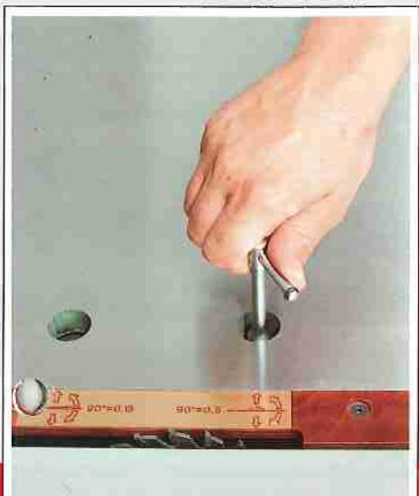
Ampia accessibilità al gruppo "SEGA-INCISORE" per la sostituzione delle lame. Il convogliatore di trucioli è a carenatura totale per una efficace aspirazione e massima pulizia all'interno della macchina.
