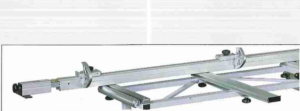
La guida telescopica è concepita per avere sempre un'ampia superficie d'appoggio ed apposite battute dotate di lente d'ingrandimento sono regolabili a scomparsa e permettono una regolazione molto precisa delle misure di taglio.
