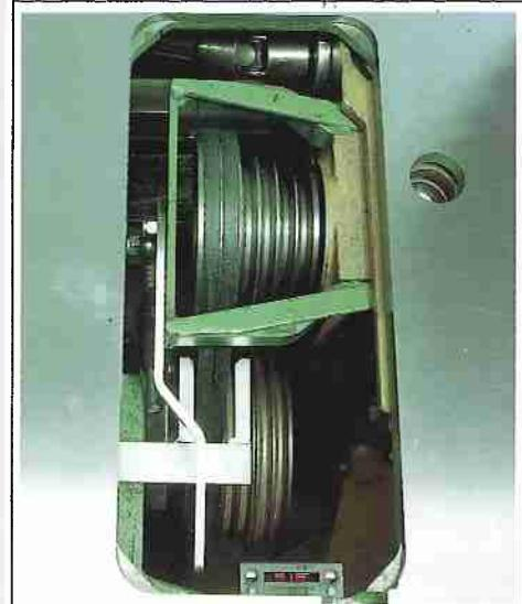
Incisor con motorizzazione indipendente e regolazioni centesimali, ottenute grazie ad un sistema di VITE SENZA FINE - RUOTA A DENTI ELICOIDALI. Si accede a tali regolazioni attraverso appositi fori sul piano.
