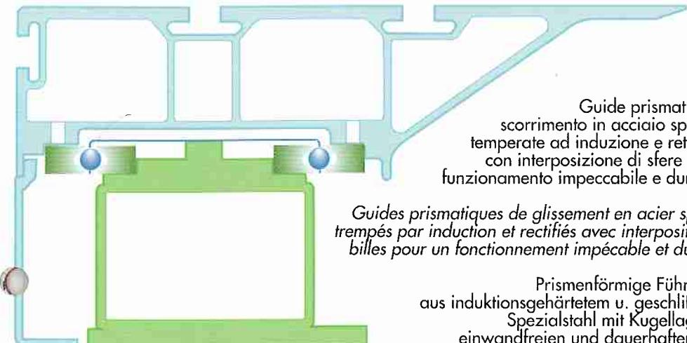
Il sistema di scorrimento prevede un punto di contatto limitato con elevato carico sulle sfere, questo mantiene lo scorrimento agile e la guida costantemente pulita.
