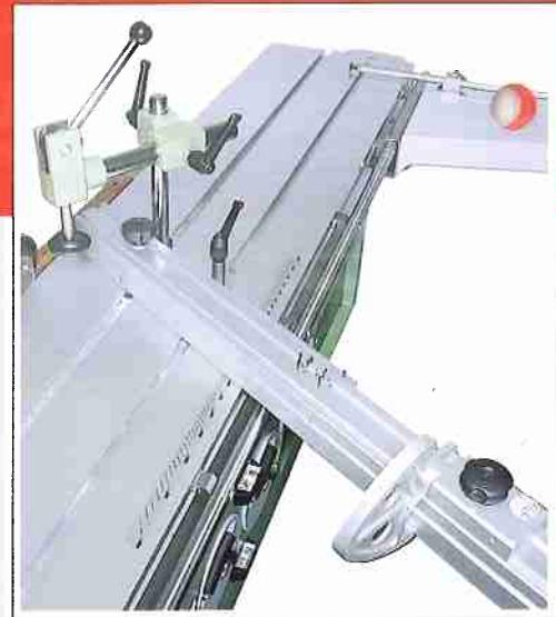
Guida telescopica per tagli inclinati di facile e rapida regolazione. Il suo ampio dimensionamento permette un appoggio sicuro ed un taglio molto preciso.
