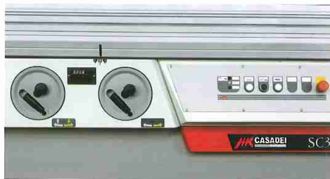
Quadro comandi con volantini fissi delle versioni a movimentazione manuale. Cuadro de mandos con volantes fijos de las versiones con movimiento manual.
