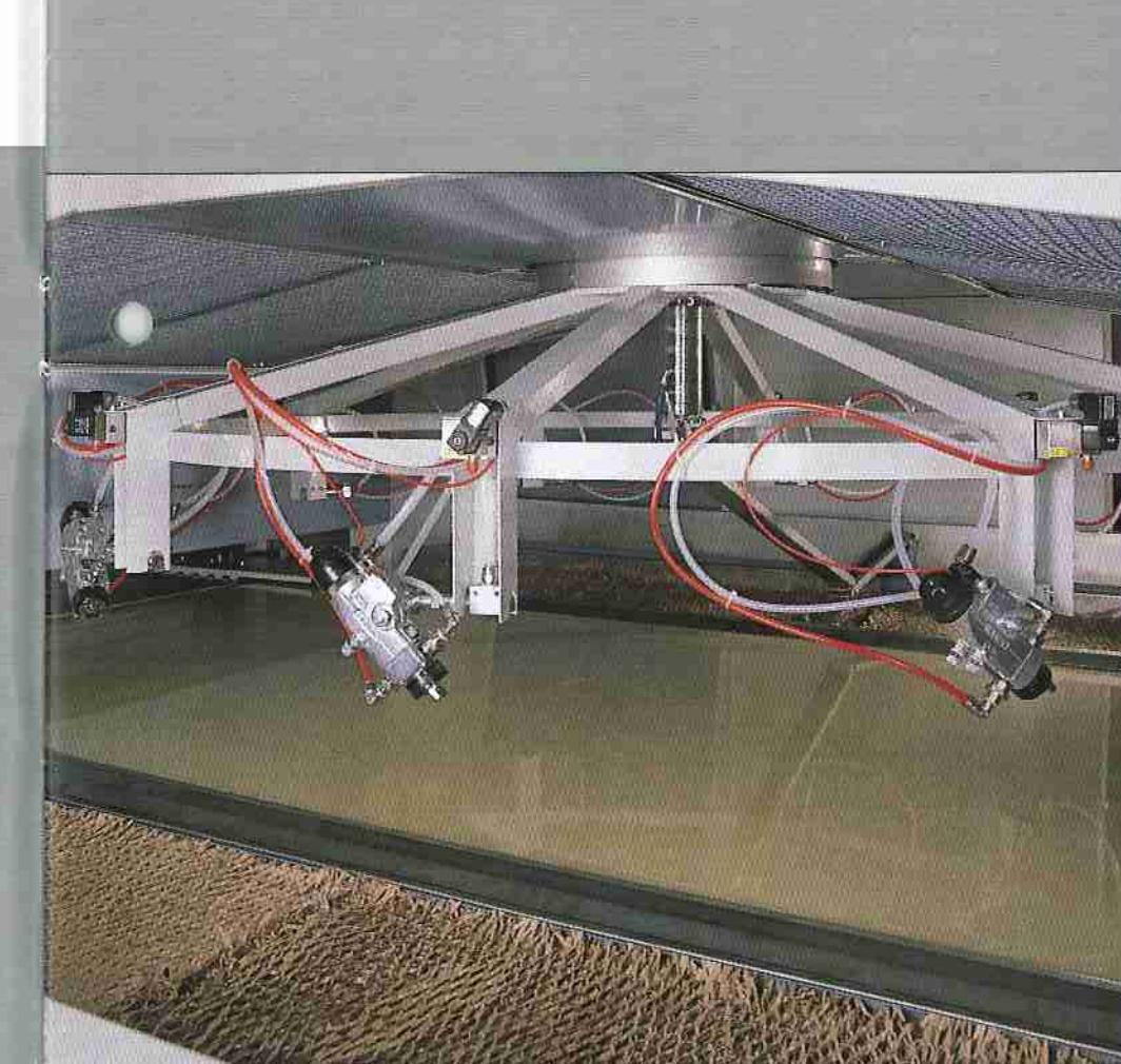
Il sistema di trasporto pezzi con nastro in fibra di carbonio CFB garantisce lunga durata d'impiego e assenza di overspray nella parte inferiore dei pezzi.
