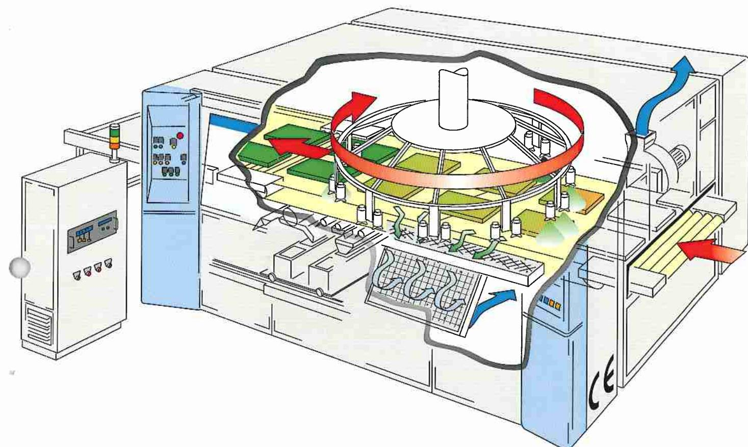
Il sistema di aspirazione con doppia serie di filtri ad efficienza progressiva consente di contenere l'emissione dei particolato solido entro le normative vigenti. La barriera di lettura a 60 fotodiodi permette una lettura fedele del pezzo e l'ottimale controllo dei parametri di spruzzatura.
