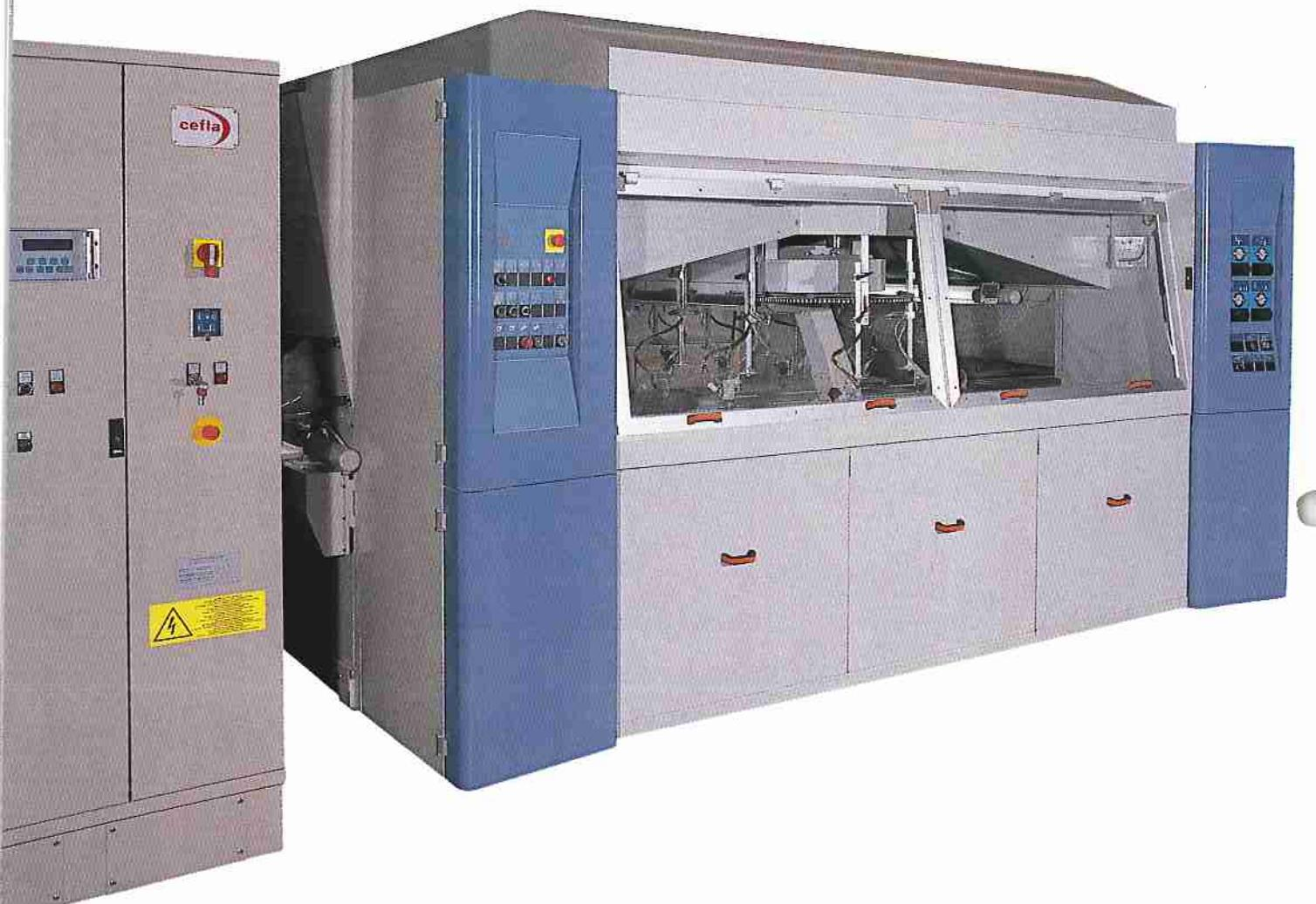
La Elispray è una spruzzatrice automatica per linee ad alta produttività (10 – 12 mt/min), particolarmente studiata per l'applicazione di vernici termoindurenti.
