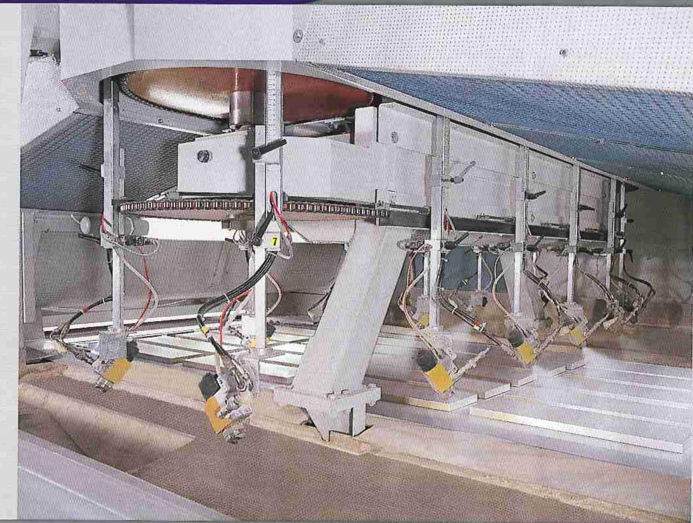
La Elispray può montare 12, 16 o 24 pistole in due circuiti prodotto indipendenti con ricircolo. Il prodotto viene distribuito alle pistole da un gruppo di distribuzione rotante. Il moto ellittico delle pistole consente l'ottimale applicazione sul pezzo con ottima Transfer Efficiency.
