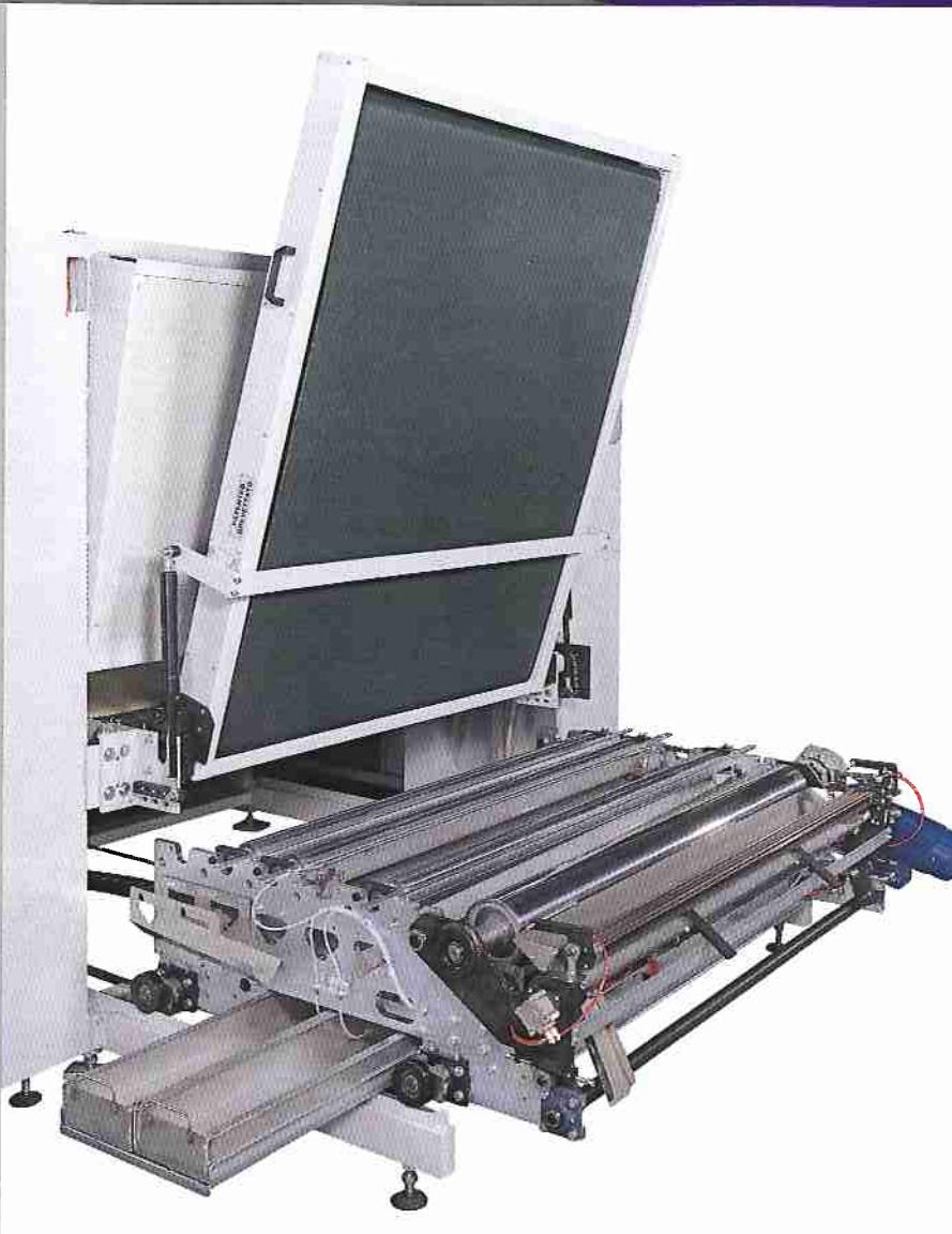
Il carrello di pulizia ad estrazione longitudinale riduce drasticamente i tempi di pulizia e permette l'ottimale recupero della tinta.
