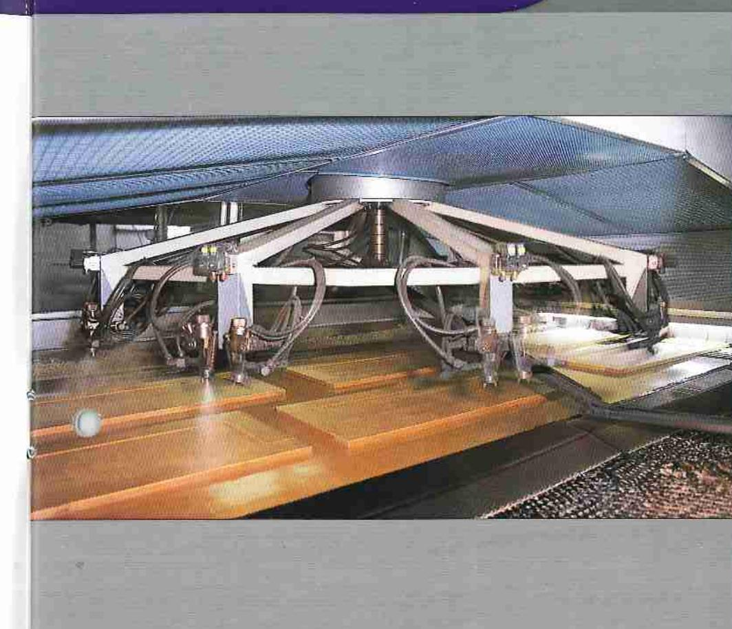
Il sistema di spruzzatura prevede un gruppo di distribuzione rotante che alimenta 10 pistole tramite uno o due circuiti completi di ricircolo.
