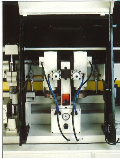
Grupo de pre-fresado PF-7 compuesto por dos motores antiastilla de 1,5 Kw c/u, para la limpieza del canto del tablero previo a la operación de encolado sobre una altura de panel de 30 mm.
