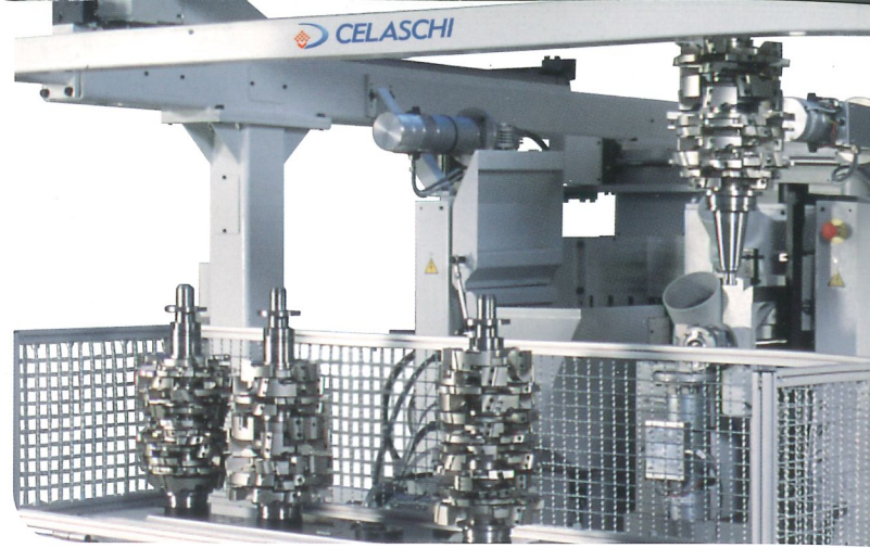
Magazzino utensili automatico Automatic tools magazine Automatisches Spindelmagazin Almacen utensilios automatico Magasin outils automatique
