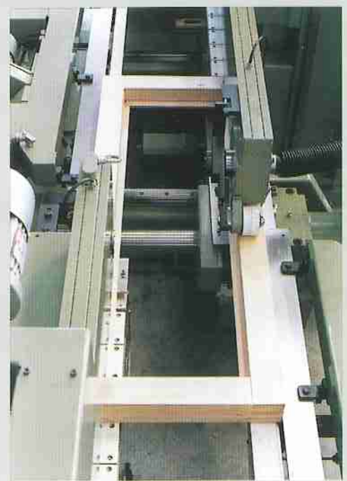
Fuoriuscita ante squadrate nei 4 lati - Sortie des fenêtres calibrées sur 4 cotés - Outfeeding of window frames squared on four sides Vierseitig besäumte Flügel - Salida hojas de ventanas contorneadas en los 4 lados
