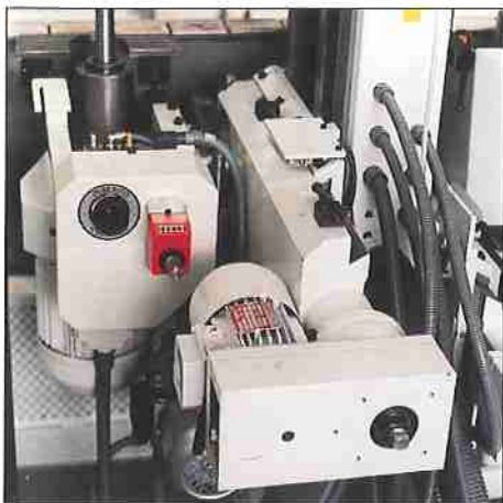
Gruppo levigatore a disco con recupero usura. Disc-sanding unit with wear recovery.
