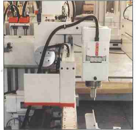
Gruppo fresatore lato interno cingolo. Swing-arm milling/moulding unit.
