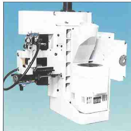
Gruppo tenonatore multiplo con para- schegge automatico.
