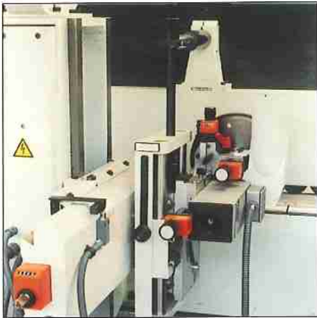
Motore fresatore con tastatori. Finishing unit with tracers.
