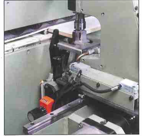
Gruppo arrotondatore elettronico degli angoli. Electronic corner-rounding unit.
