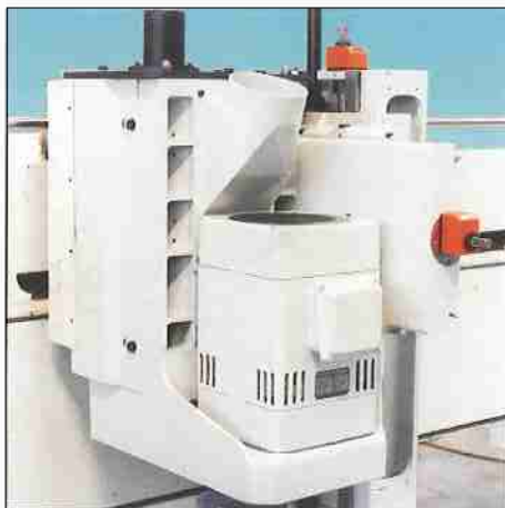
Motore fresatore con albero contro- supportato.
