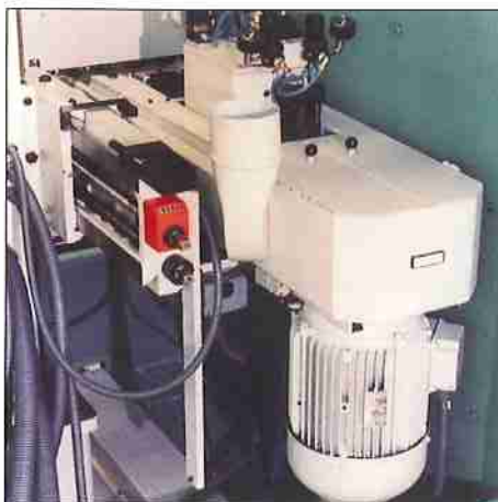
Gruppo levigatore a nastro per profili piani. Belt-sanding unit for straight edges.
