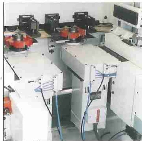
Motore ad alta precisione per sago- matura elettronica.
