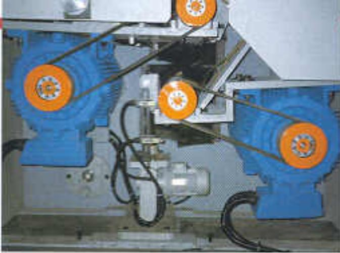
Der Zahnkeilriemenantrieb der Sägewelle gewährleistet höchste Funktionalität und Zuverlässigkeit:
