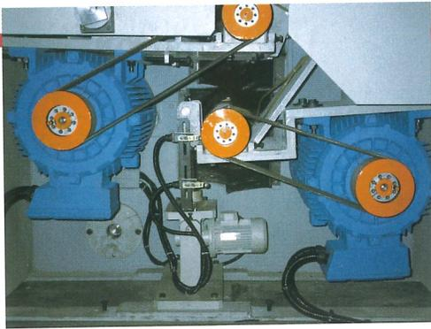
Der Zahnkeilriemenantrieb der Sägewelle gewährleistet höchste Funktionalität und Zuverlässigkeit:
