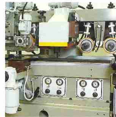
Gruppo pialla spessore Thickness/planing unit Grupo cepillo espesor Dickenhobelaggregat Группа строжки по толщине
