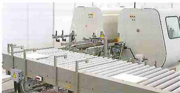
1) Esempio di introduzione pannello per 2 a lavorazione, con pezzo in appoggio al piolino. Panel infeed system: the workpiece is laying against the dog. Ejemplo de introducción del panel para la 2da. elaboración, con pieza en apoyo contra el tope. Beispiel Einführung einer Platte für 2. Verarbeitung mit Werkstück an Mitnehmer angelegt. Пример для ввода панели для 2-й обработки, обрабатываемый элемент опирается на штифты.
