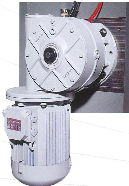
**Motoriduttore a vite senza fine comandato da inverter per consentire la regolazione della velocità di avanzamento visualizzata sul pannello di comando.**
