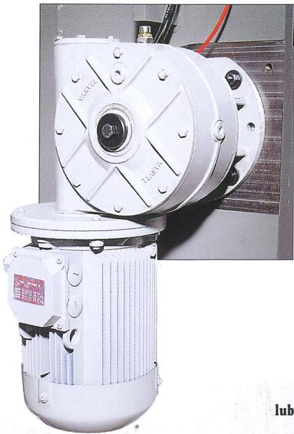
**Motoriduttore a vite senza fine comandato da inverter per consentire la regolazione della velocità di avanzamento visualizzata sul pannello di comando.**
