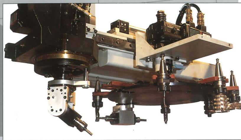
Particolare di un elettromandrino equipaggiato con asse rotante (ROTOR) gestito su 360 gradi da CNC e magazzino utensili per cambio automatico.
