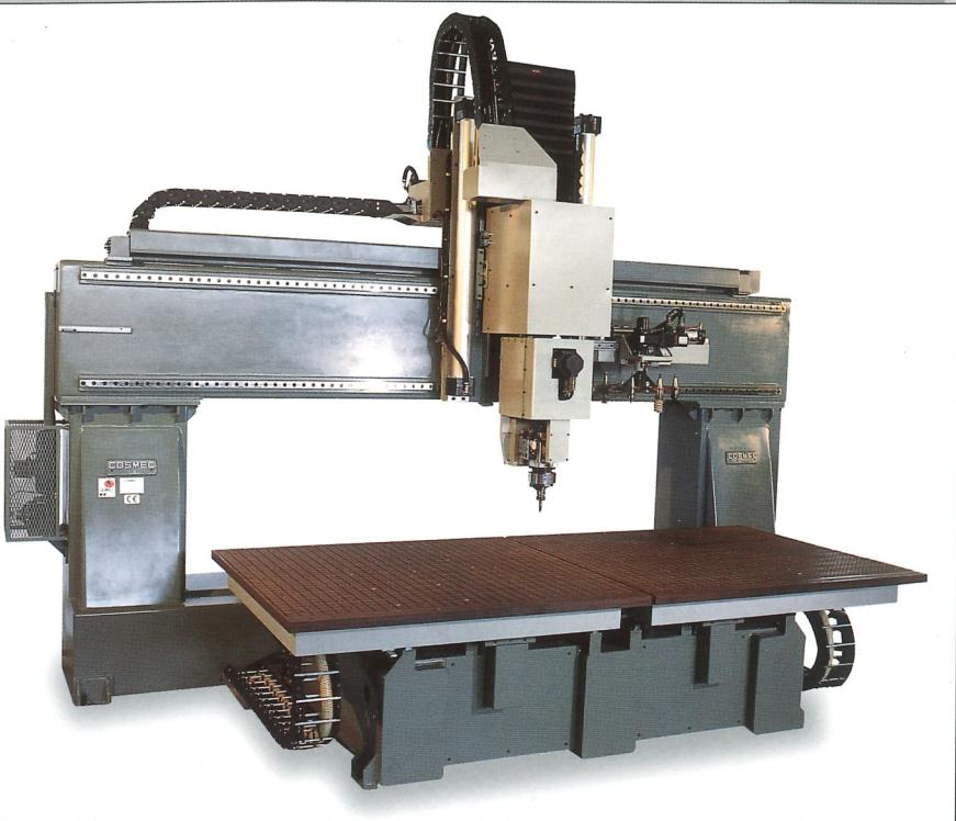
Centro di lavoro con 3 elettromandrii con cambio automatico dell'utensile e magazzino portautensili sui quali possono essere montati rinvii angolari.
