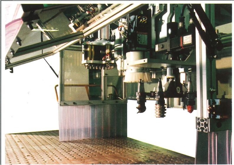
Veduta del gruppo testa, all'interno della protezione, dalla quale si può rilevare la forte struttura dei componenti che assicurano la mancanza assoluta di vibrazioni anche in situazioni di notevole sforzo.
