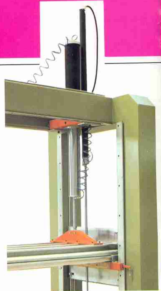
Verin télescopique pour réduire la hauteur totale de la cadreuse.
