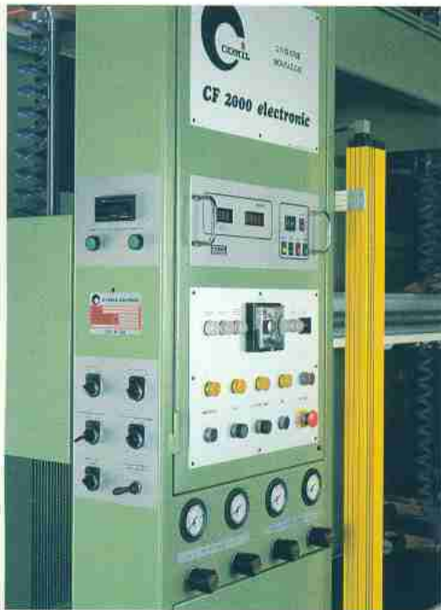
Commandes supplémentaires pour des changes rapides de pression et pour des agrégats spéciaux.
