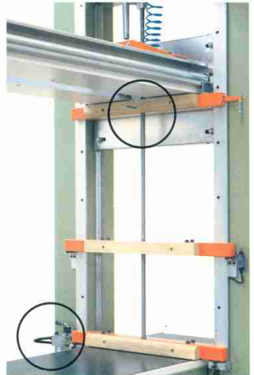
Butées transversales et dispositifs pour le positionnement des meubles et de la poutre de pression verticale.
