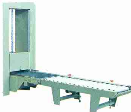
Voie à rouleaux inclinés de rattachage entre la chaîne d'assemblage et la cadreuse.
