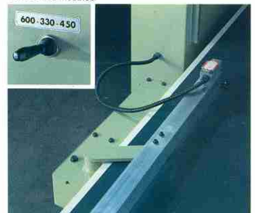
Butée pneumatique à trois positions pour les profondeurs variées des meubles.
