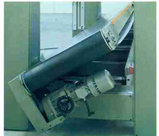
Soulèvement automatique du transport pour recharger le tapis.
