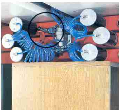
Microswitch de sécurité aux agrégats horizontaux.
