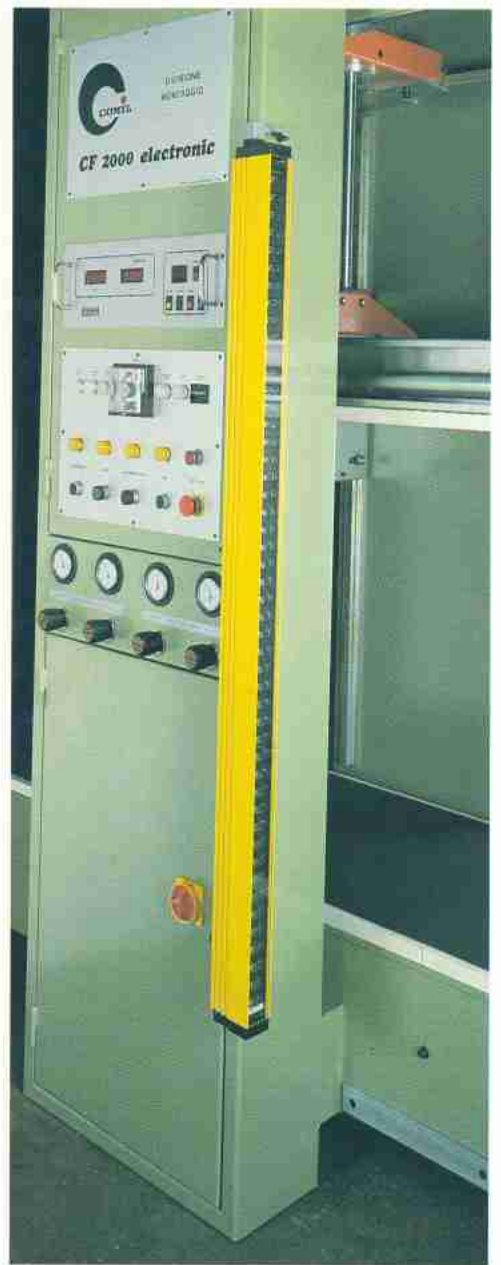
Détail barre photocellules de sécurité à protection intégrale.
