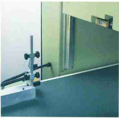
Photocellules multiples pour reconnaître la longueur et hauteur de meubles spéciaux.
