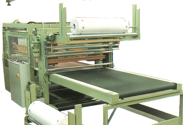
Machine spéciale avec le dispositif de soudage latéral pour emballage avec double film de polyéthylène et polystyrène.
