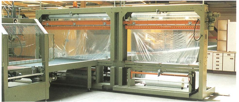
2 filmeuses déplaçables en-chaine sur deux rails indépendants et tapis intermédiaire.
