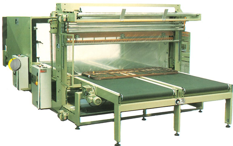
Machine spéciale pour l'emballage transversal des portes, fenêtres, matelas, sommiers métalliques, etc...
