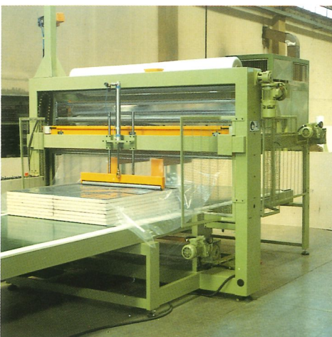
Aggrégat de pressage supérieur pour les pièces empilées.
