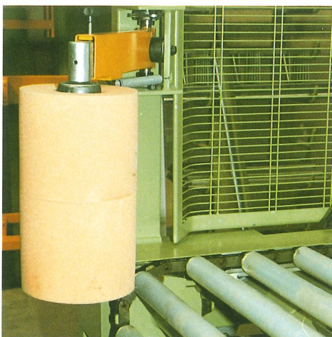
Détail du transporteur à lattes-rouleaux, revêtus en silicone-caoutchouc et agrégat de pressage des bouts du film latéral.
