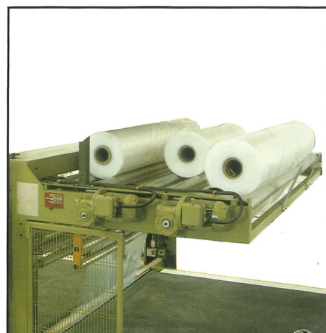
Détail de la filmeuse à 3 rouleaux de film motorisés.
