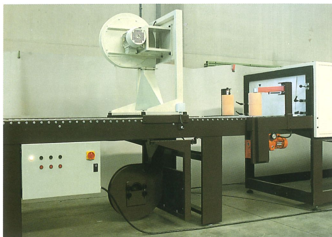
Aggrégat de refroidissement supérieur et inférieur à la sortie du tunnel.
