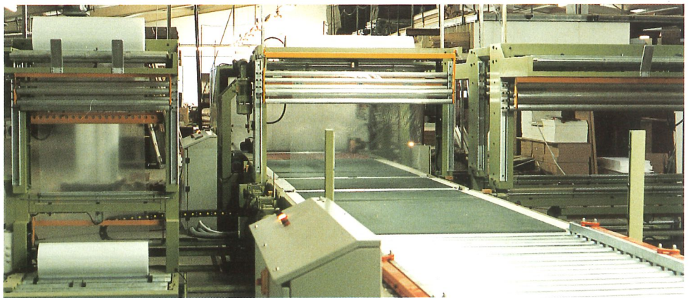
4 Filmeuses déplaçables indépendamment sur deux rails et tapis intermédiaire.
