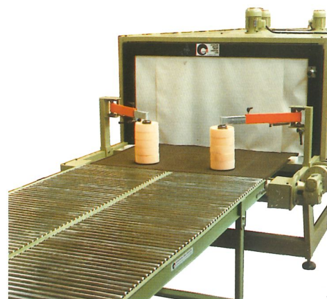
Voie à rouleaux libres ou motorisés pour le refroidissement et déchargement des meubles emballés et éventuellement leur passage au stock ou à l'expédition.
