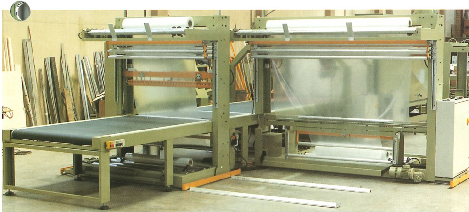
4 Filmeuses déplaçables indépendamment sur deux rails et tapis intermédiaire.
