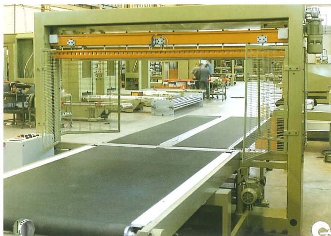
Transporteur à tapis double pour l'application des protections d'angle dans le tapis en entrée de l'emballuse.
