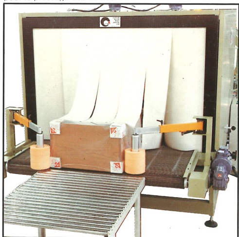
Sortie du tunnel des pièces emballées et dispositif latéral pour le pressage des bouts du film.
