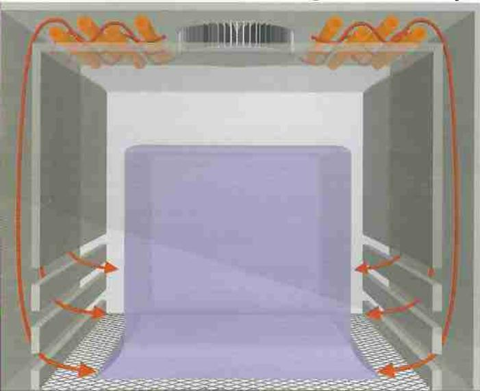
Dentro del túnel, el aire calentado por las resistencias circula de manera uniforme gracias a unos ventiladores. Para facilitar las operaciones de mantenimiento tanto los ventiladores como las resistencias se encuentran en la parte superior del horno de retracción.
