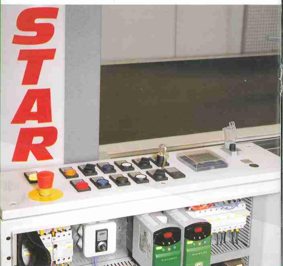
Tanto las bandas de la empaquetadora como el transporte con red del túnel de retracción están gobernados por un inverter (variador de frecuencia), para manejar las velocidades de manera flexible e independiente.
