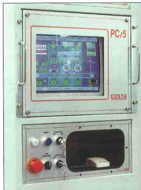
**PC.5** è il sistema computerizzato di controllo macchina più conveniente. Non dispone di tastiera ma solo di mouse.
