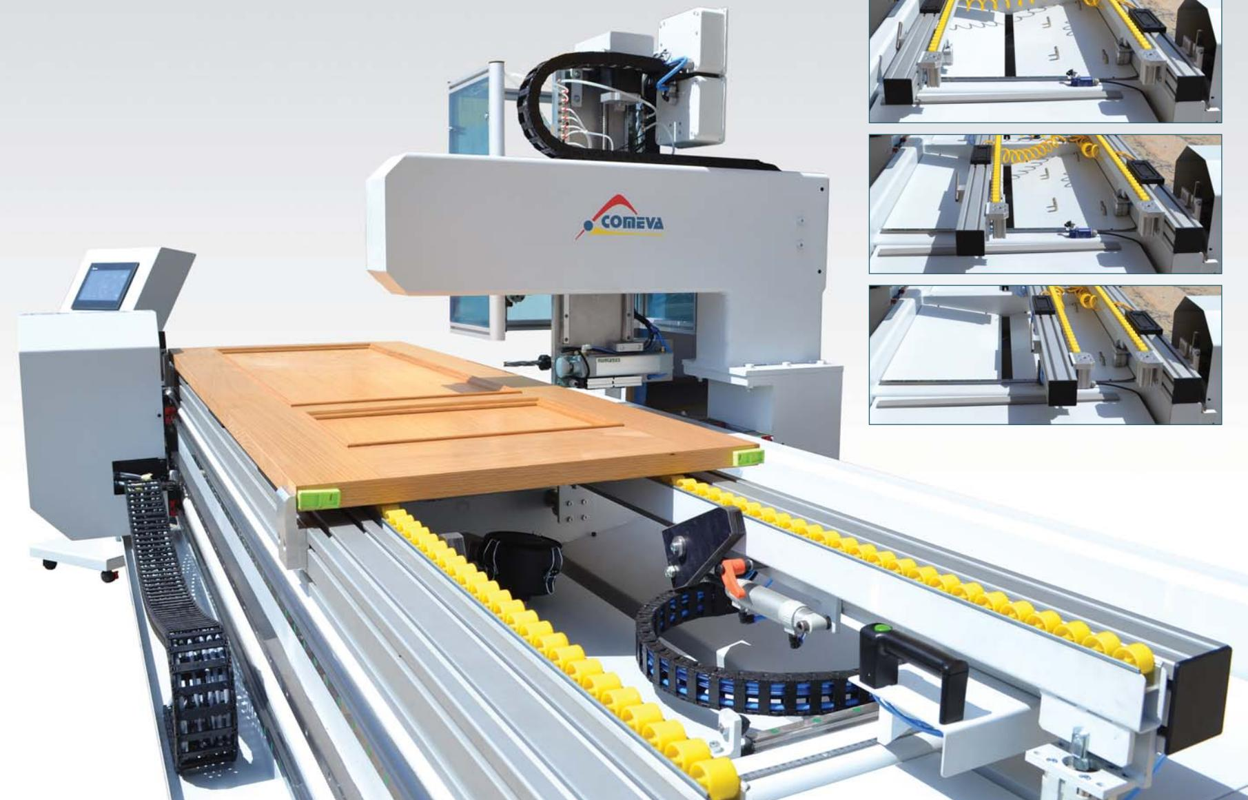
Fraiseuse de portes programmable avec une construction robuste et solidité.
