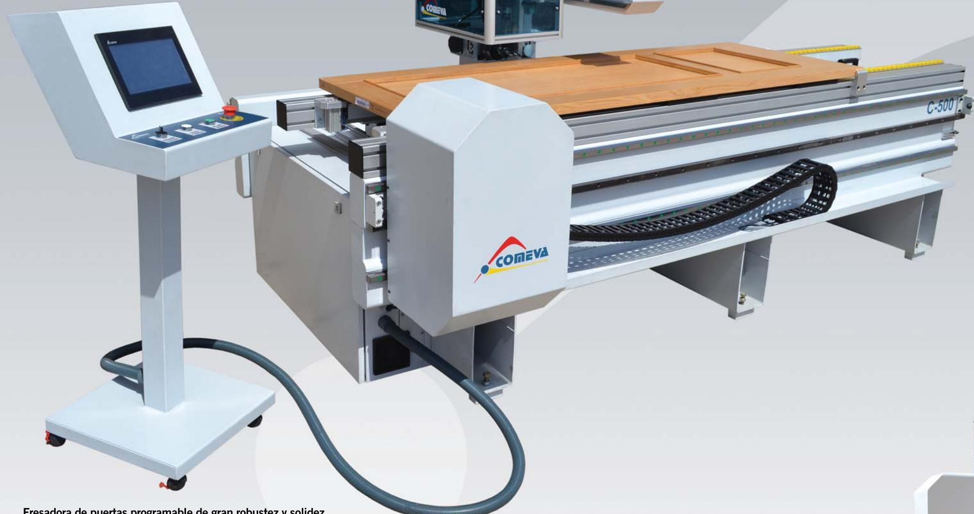
Fresadora de puertas programable de gran robustez y solidez en su construcción. Dispone de ciclos para la realización del mecanizado de la cerradura, bisagras y pomo en puertas y ciclos para mecanizado de bisagra y contra placa en los cercos. Consola de control independiente de pantalla táctil y programación sencilla e intuitiva con las principales macros instaladas.
