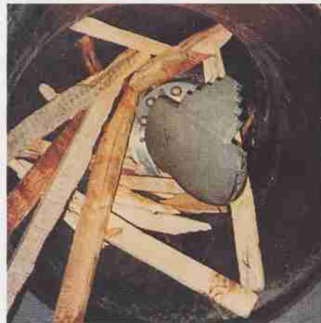
Blick von oben in den Vorfüllschacht des Rotationsschneidbrechers R 71
