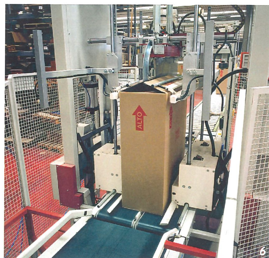
Rappresentazione chiusura lembi superiori scatola. Representation of upper box flaps closing.
