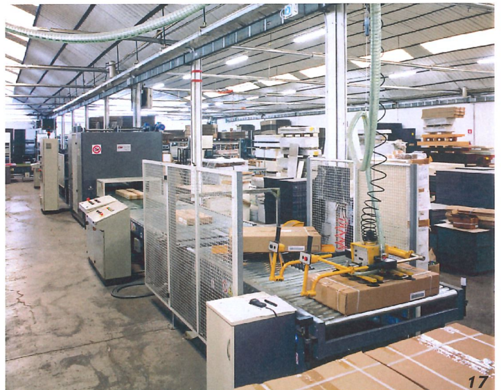
Uscita colli dall'impianto di chiusura con nastro adesivo e successiva reggiatura. Outfeed of packages from adhesive tape closing unit and subsequent strapping.
