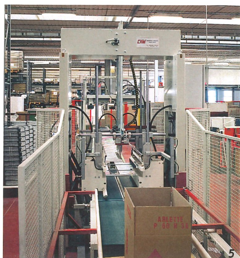
Organi di chiusura superiore scatole. Upper box closing organs.
