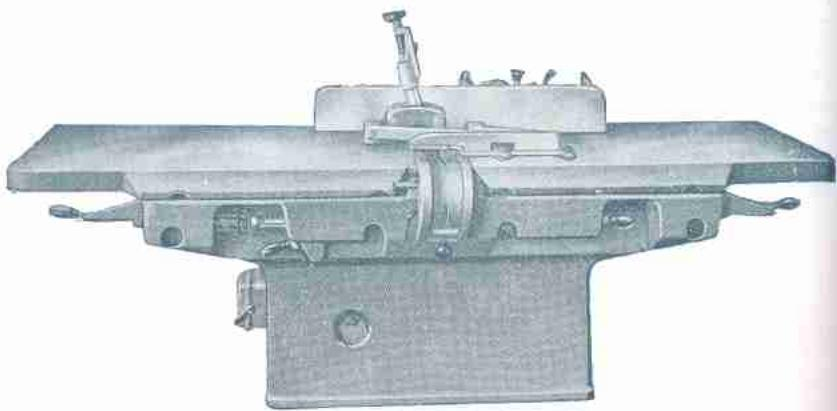
**Schwere Genaugkeits-Abricht-, Füge- und Kehlmaschine Typ: AFK 4 und AFK 6**
