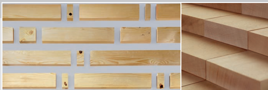
定寸カット 欠点除去 オプティマイジング（最適木取り）
