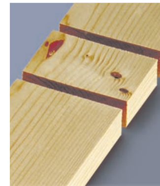
Auskappen von Fehlern bei gleichzeitigem Längenzuschnitt
