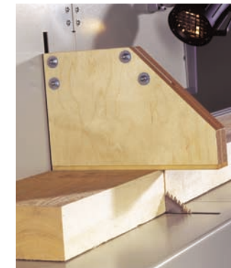
Gefahrlos arbeiten ohne Hände im Schnittbereich, Werkstücke werden automatisch gespannt
