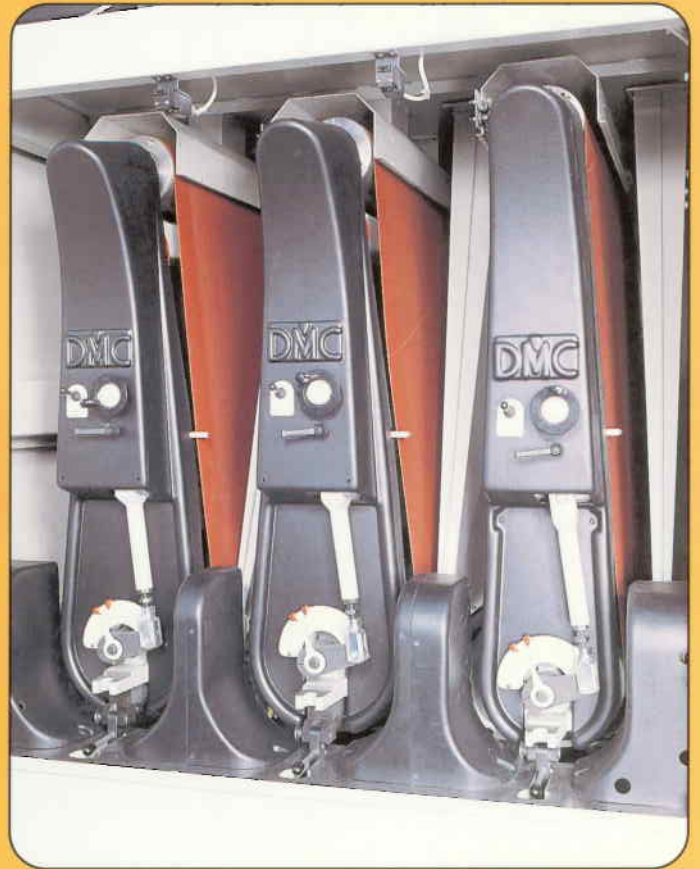
M3 250 mm Roller - 320 mm Roller - 320 mm Roller Walze 250 mm - Walze 320 mm - Walze 320 mm
