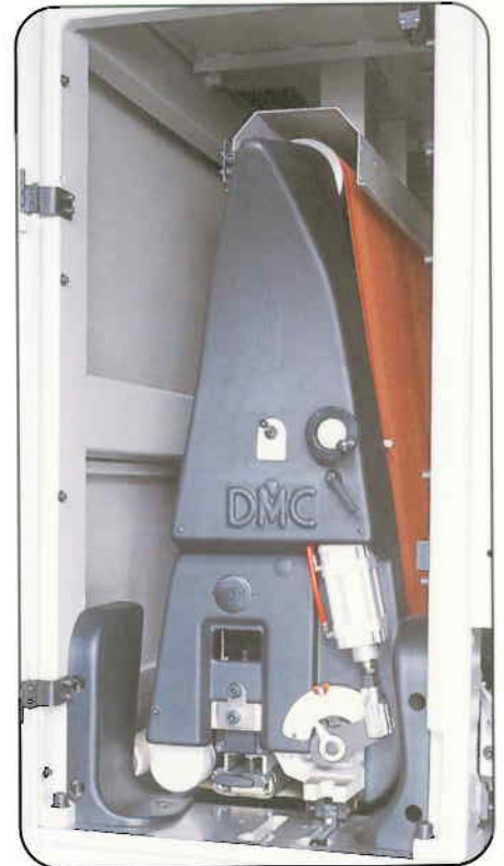
M1 Combi with EPICS pad. Kombinierte Gruppe mit Schleifschuh EPICS
