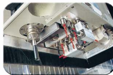
Cabezal de taladro de 13 brocas verticales, 6 horizontales + sierra
